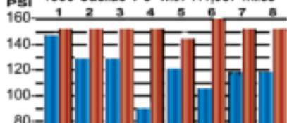
Note en la gráfica el incremento de la compresión en cada uno de los cilindros y mejor balance entre ellos, antes de los mil kilómetros.
